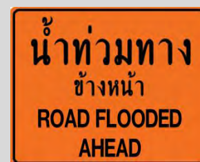
รูปที่ 2-3 ตัวอย่างอุปกรณ์ควบคุมการจราจร เพื่อบอกเส้นทางชั่วคราว เมื่อทางขาดเนื่องจากภัยธรรมชาติ
